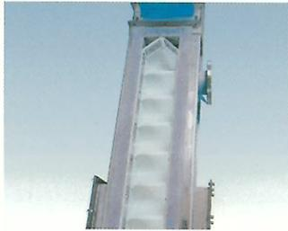
投入口は各バケットのフランジ部どうしが重なり合い「こぼれ」を防ぎ、スクレーパー（標準ネオプレン、又はテフロン板）により飛散や残留を防止しており確実にバケット内に投入します。
